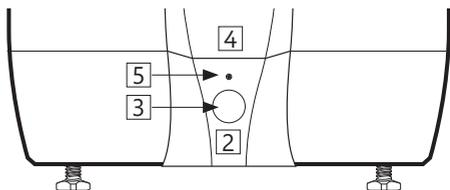
Опорожнив бак, закройте предохранительный клапан, поворачивая ручку (3) дальше по часовой стрелке. Закройте все открытые краны. Установите смесительный клапан в первоначальное положение. Установите на место крышку (2) над предохранительным клапаном.
